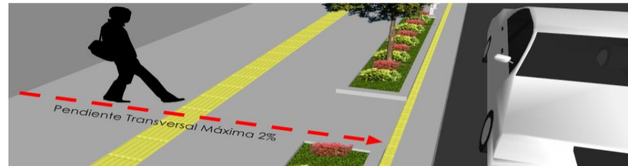
Pendiente transversal de andén tipo. Esquema indicativo
