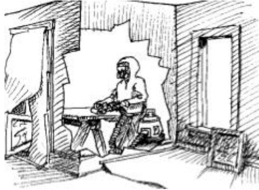
Máquinas con filtro de partículas de aire de alta eficiencia (HEPA) Fuente: Lead paint Safety, Housing and urban development (HUD), 2001.
