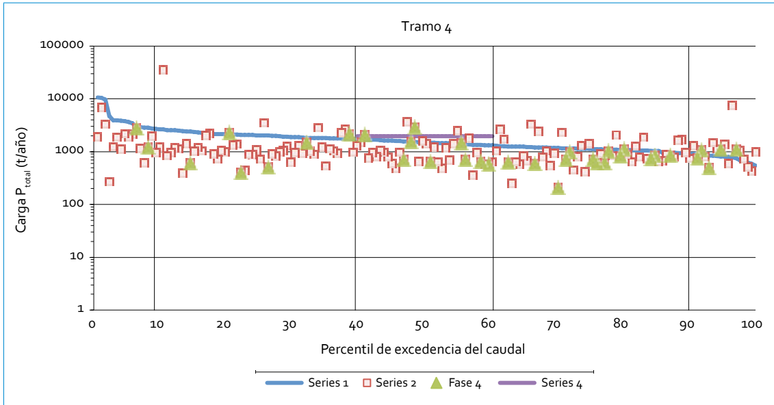
FIGURA 4.25. Curva de duración de carga P_{total} : río Fucha
