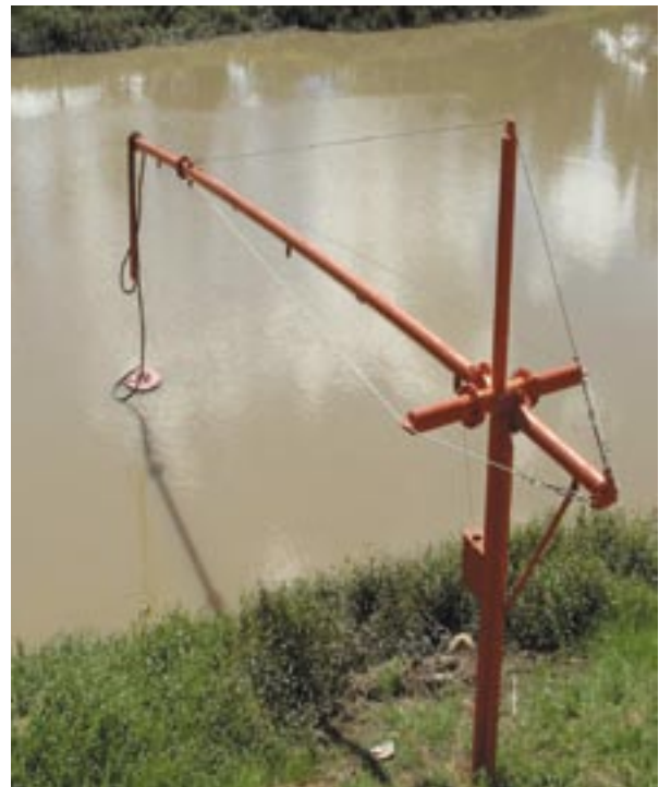
Foto 2. Estructura metálica de las estaciones remotas fijas.
